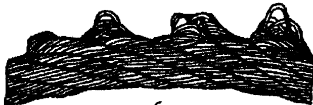
Рисунок 12. Выдавливание проволок прядей:
