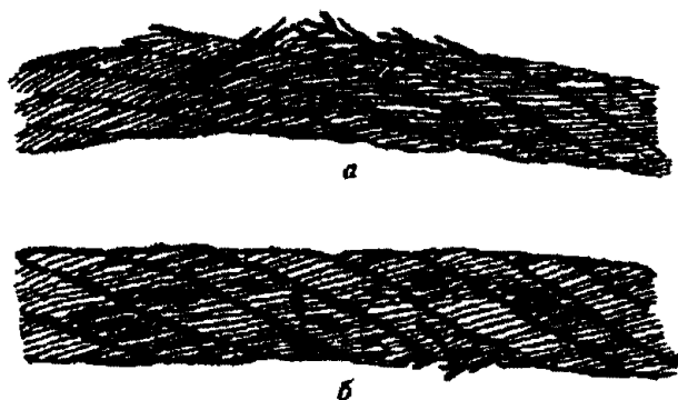
Рисунок 3. Обрывы проволок в зоне уравнильного блока:
