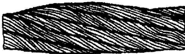
Рисунок 13. Местное увеличение диаметра каната.
